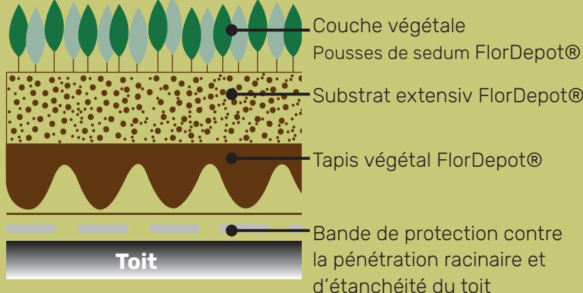
Le poids total de cette toiture végétale est de 71,50 kg/m<sup>2</sup> (entièrement saturé) et a un volume tampon d'eau de 35 l/m<sup>2</sup>.
